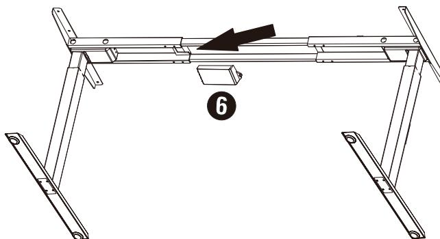
10-Instalar los CABLES de los MOTORES<sup>1</sup>. El motor próximo al TRANSFORMADOR<sup>6</sup>, se conecta con su cable corto, y el cable lejano al TRANSFORMADOR<sup>6</sup> se conecta agregándole la extensión del cable incluida<sup>9</sup>. En sus entradas correspondientes.
