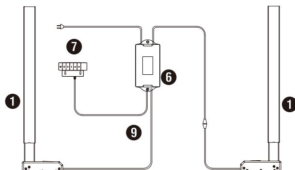
13-Una vez su estructura se encuentre nivelada y con sus APOYOS <sup>8</sup> en contacto con el PISO, conecte el SHCUKO <sup>9</sup> a su toma correspondiente y eleve su altura a su máximo dejando apretado la flecha hacia arriba de su CONTROL <sup>7</sup>. Asegúrese de que no existan obstáculos en su rango de altura y de que el largo del cable sea suficiente. En caso de contar con el accesorio de bandeja de cables (vendido por separado), es recomendable instalarla previo a instalar su mesada.
