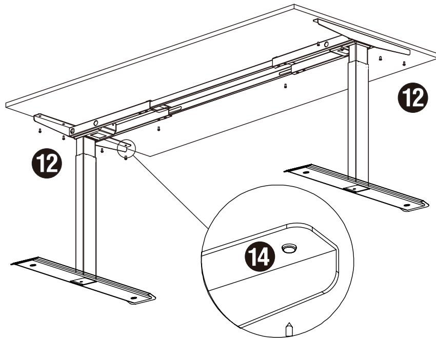
Tenga cuidado al fijar los tornillos de que no sean más largos que el espesor de su mesada. A la hora de fijar los dos puntos centrales del riel con la mesada, debe deslizar el TRANSFORMADOR <sup>6</sup> para acceder al mismo temporalmente.
