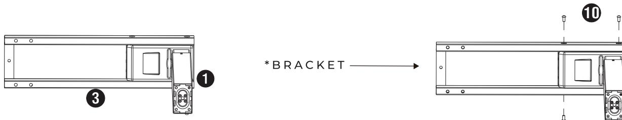
4-Unir cada LATERAL <sup>5</sup> (ubicados en la bandeja superior) a cada RIEL <sup>3</sup> con los TORNILLOS de cabeza CHATA <sup>11</sup> en sus dos puntos de anclaje superiores.
