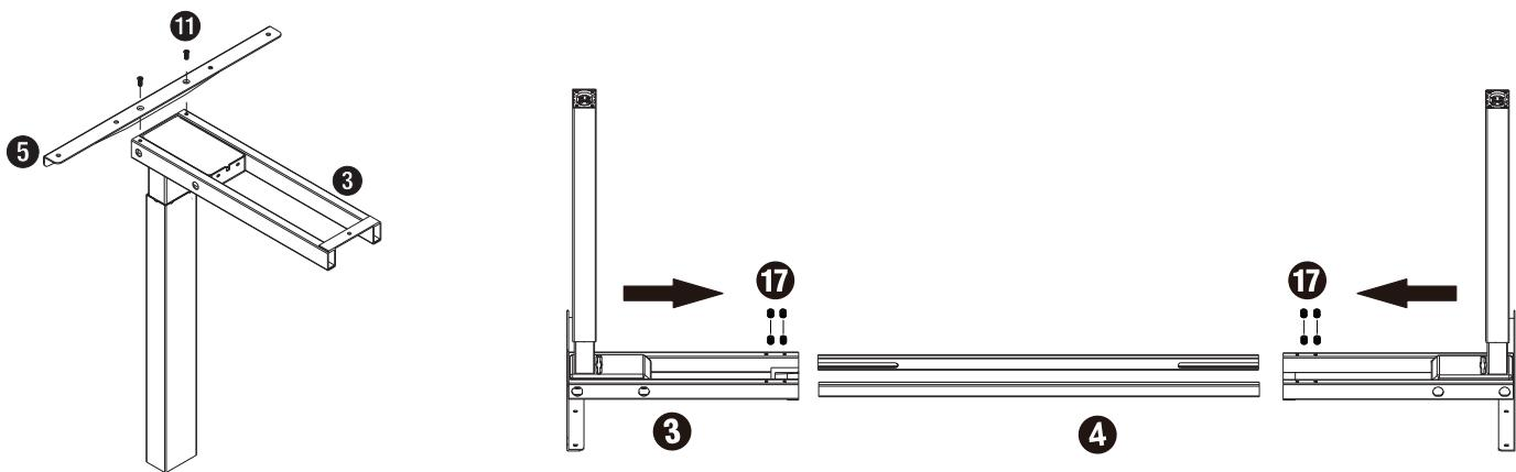
5-Introducir y fijar los PERFILES TELESCÓPICOS <sup>4</sup> (previamente removidos) en cada lado del RIEL <sup>3</sup>, asegurándose de que los rebajes miren hacia su interior.
