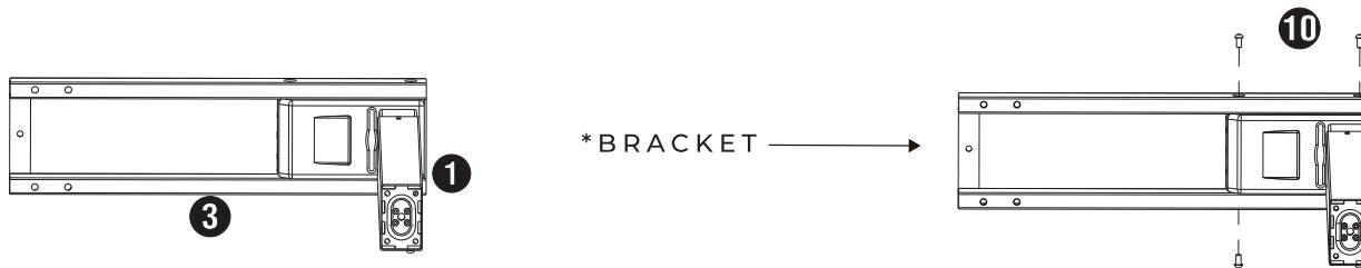
4-Unir cada LATERAL <sup>5</sup> (ubicados en la bandeja superior) a cada RIEL <sup>3</sup> con los TORNILLOS de cabeza CHATA <sup>11</sup> en sus dos puntos de anclaje superiores.
