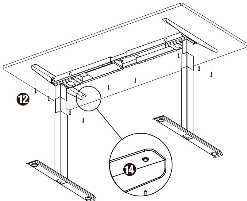
Tenga cuidado al fijar los tornillos de que no sean más largos que el espesor de su mesada. A la hora de fijar los dos puntos centrales del riel con la mesada, debe deslizar el TRANSFORMADOR <sup>6</sup> para acceder al mismo temporalmente.
