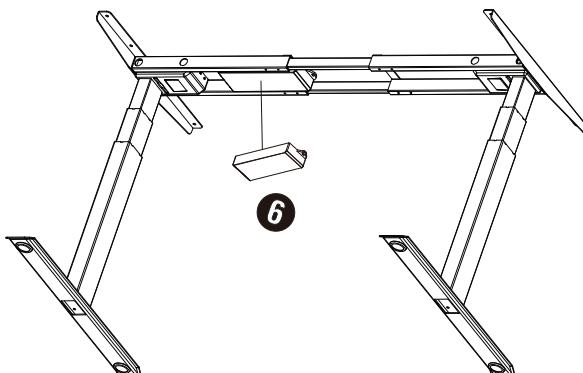
10-Instalar los CABLES de los MOTORES<sup>1</sup>. El motor próximo al TRANSFORMADOR<sup>6</sup>, se conecta con su cable corto, y el cable lejano al TRANSFORMADOR<sup>6</sup> se conecta agregándole la extensión del cable incluida<sup>9</sup>. En sus entradas correspondientes.
