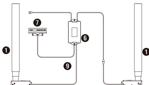
13-Una vez su estructura se encuentre nivelada y con sus APOYOS <sup>8</sup> en contacto con el PISO, conecte el SHCUKO <sup>9</sup> a su toma correspondiente y eleve su altura a su máximo dejando apretado la flecha hacia arriba de su CONTROL <sup>7</sup>. Asegúrese de que no existan obstáculos en su rango de altura y de que el largo del cable sea suficiente.
