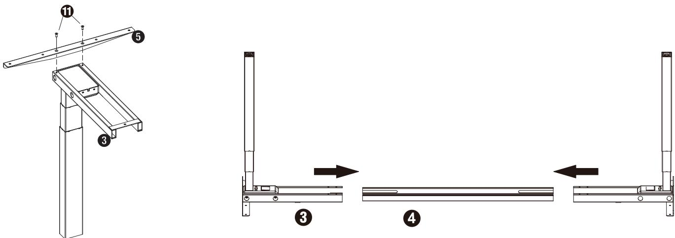
5-Introducir y fijar los PERFILES TELESCÓPICOS <sup>4</sup> (previamente removidos) en cada lado del RIEL <sup>3</sup>, asegurándose de que los rebajes miren hacia su interior.
