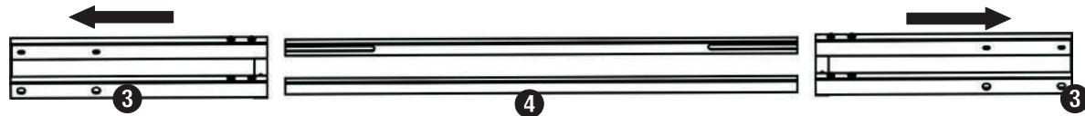
3-Unir cada RIEL <sup>3</sup> con cada PILAR <sup>1</sup> (ubicados en la bandeja inferior) utilizando los TORNILLOS de cabeza DOMO <sup>10</sup> en los 4 puntos laterales con la llave de Allen.
